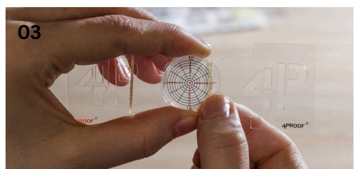
Monitor senkrecht über dem Riss platzieren. Der Kleber muss vorne aus den Poren treten (Verankerung).
